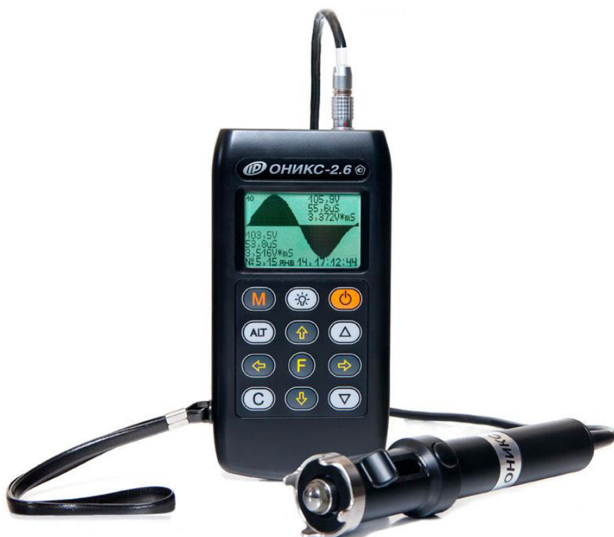
Рисунок Ж.1. Электронный склерометр ОНИКС-2.6 (Версия 1)
